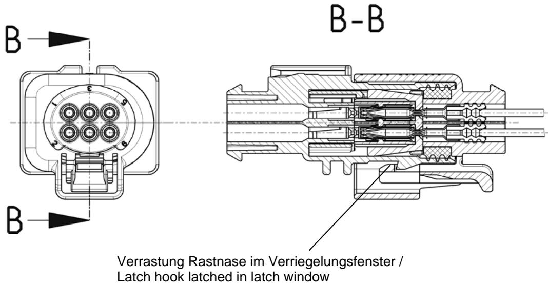
Abb. 2.2 Montierte Darstellung
